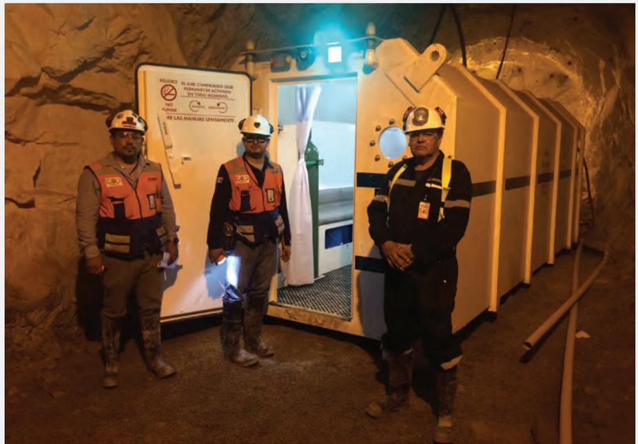
Dichos refugios pueden ser móviles o fijos, construidos usualmente en cavidades o cavernas de roca competente reforzada con pernos de anclaje o concreto lanzado. Cabe destacar que su ubicación y capacidad son determinadas por un análisis de riesgo de incendio o derrumbes, así como por el número de trabajadores presentes en las diferentes secciones de la mina.
