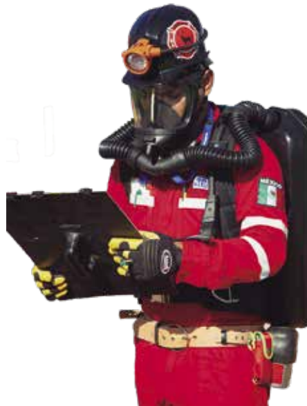
Equipo autónomo de oxígeno para exploración de minas subterráneas
