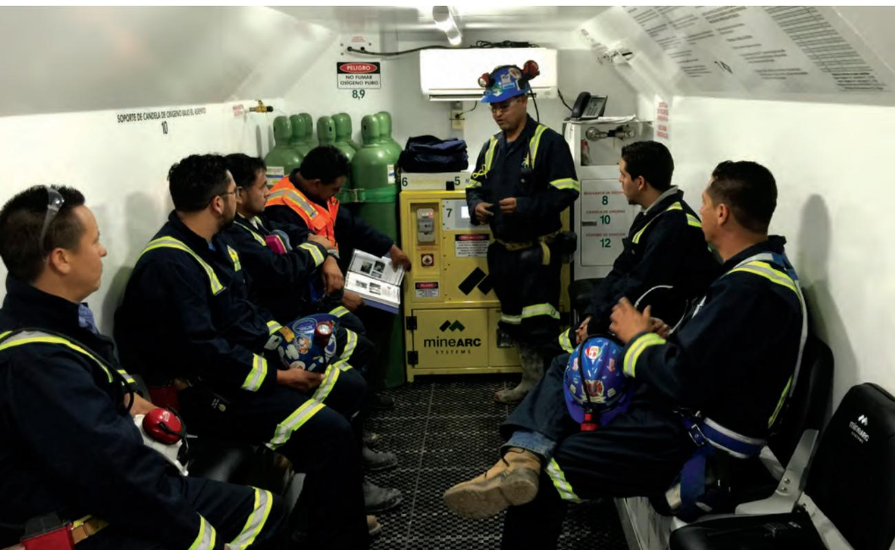
Las cámaras están acondicionadas para recibir el aire de los compresores de la mina y filtrarlo, en caso que éste se interrumpa, entra en uso el sistema de balones de oxígeno de la cámara. La cantidad de botellas de oxígeno es calculada en función a la cantidad de personas que albergará la cámara así como el tiempo de autonomía. Cuentan también con equipo para la depuración del bióxido de carbono que se genera.
